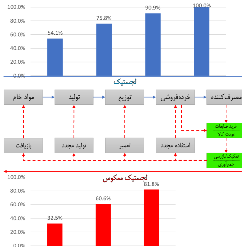
شکل ۶ - مقایسه لجستیک و لجستیک معکوس از نقطه‌نظر ارزش کالا در زنجیره تولید-توزیع-مصرف در مقایسه با استفاده‌ی مجدد-تعمیر-تولید مجدد-بازیافت
