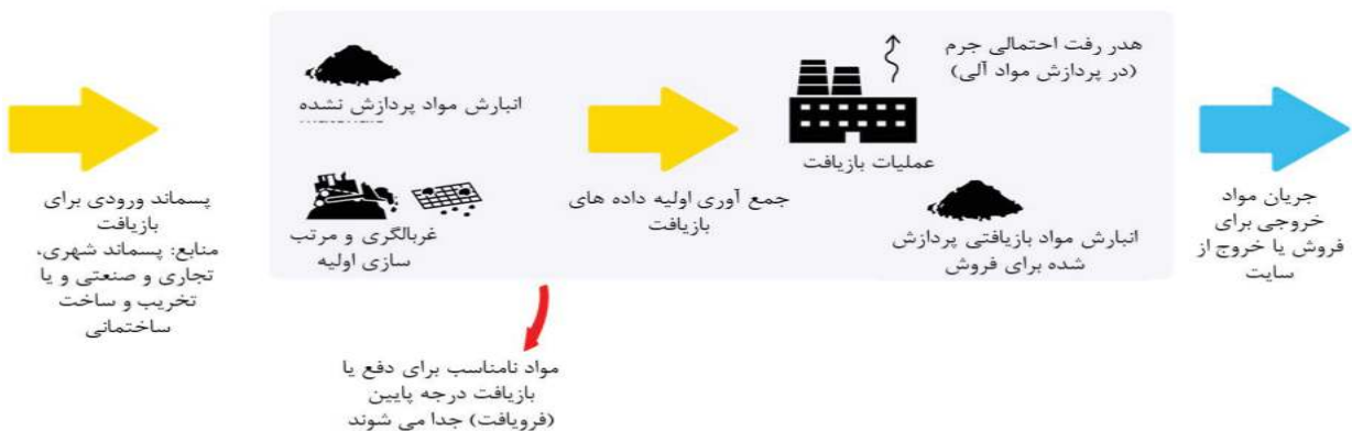
شکل ۸-۷ شماتیک فرایند بازیافت در استرالیا
