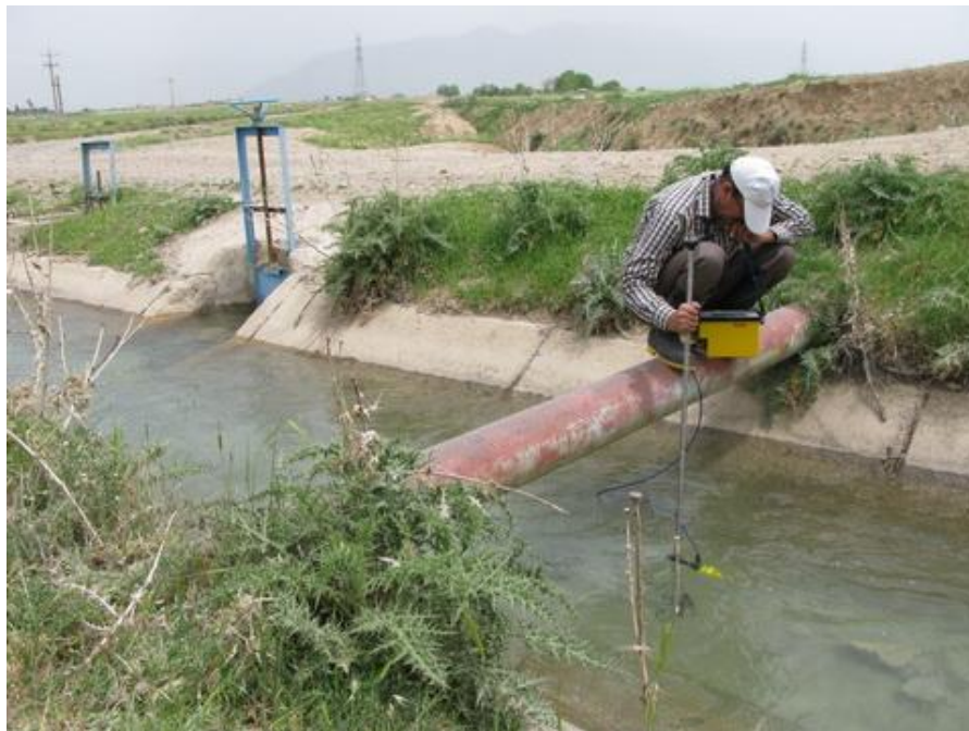
شکل ۱۰- اندازه گیری سرعت اب بوسیله میکرومولینه
